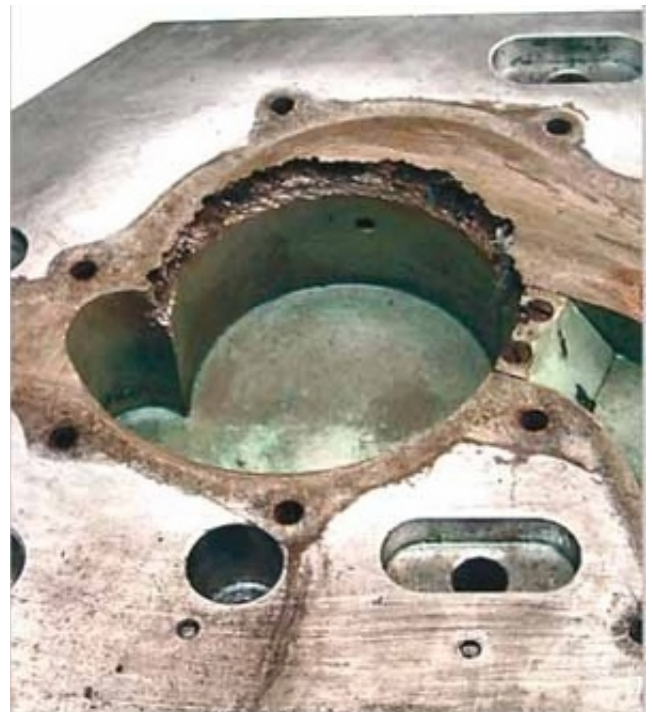
Verschleiß an einem Testwerkzeug
